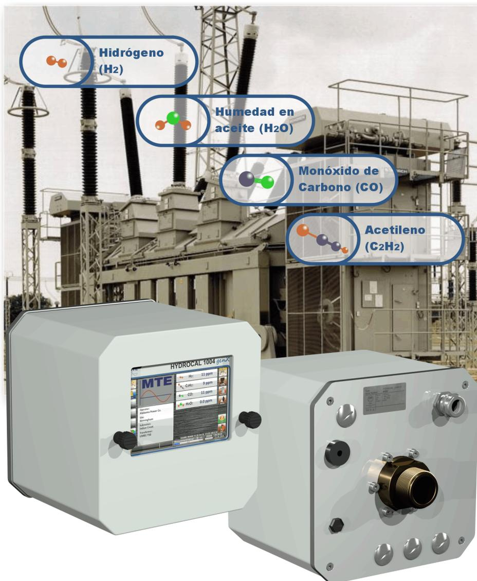
El nuevo HYDROCAL 1004 *genX* es la primera solución DGA online multi-gas verdaderamente libre de mantenimiento que combina la probada tecnología de medición "near infrared" (NIR) con extracción por membrana protegida al vacío.
